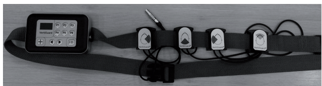
Figura 2. Aparelho de substituição vibrotátil: unidade principal e estimuladores vibrotáteis. Fonte: Brugnera et al. 1
